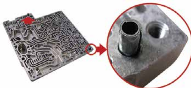
Spiralspannstifte in leichter Ausführung in einer Aluminium-Ventilkörperbaugruppe für Kraftfahrzeuge
