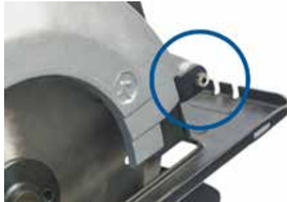
Spiralspannstifte in leichter Ausführung werden als Scharnierstifte mit Spielpassung in der Schutzvorrichtung von Handkreissägen verwendet.
